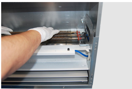
5. Miután eltávolította a csavarokat, kesztyűvel húzza ki az elektromos elemeket, nehogy megvágja magát. Fordított sorrendben szerelje vissza az új fűtőelemet.
