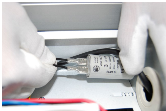
2. Húzza le a kondenzátor csatlakozását.
