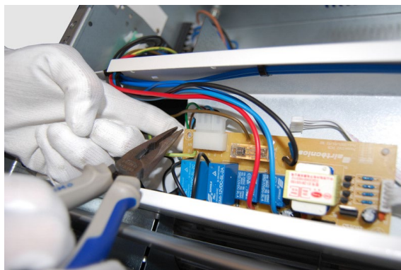
4. Szerelje le a PCB-t az elválasztókról egy szerszám segítségével.
